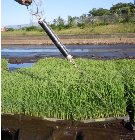
写真1 苗箱を剥ぎ取る力の計測の様子 育苗条件
