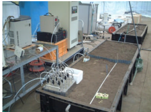
図4 専用オゾン発生装置によるドレンベッドにおける土壌処理の様子
