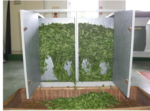
写真1 青枯れ防止板(通風コーン) 8個使用状況 (左:設置状況、右:生葉充填状況、片側4個、両側にある)
