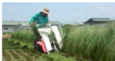
図3 米麦用バインダーでの刈取り(7月下旬) (いぐさが刈取り部に詰まるのを防ぐため2条刈バインダーでも1条ずつ刈り取る。この時、エンジン付近に取り付けてある重量バランサーを取り外すと刈取り作業時の走行は安定する。)
