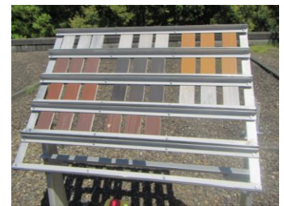
木材の処理方法別による暴露試験
