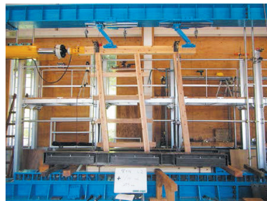
写真2 面内せん断試験事例
