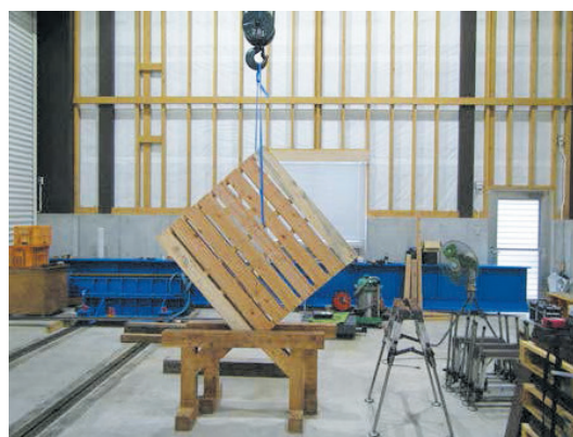
写真1 木製パレットの曲げ試験（上）及び落下試験
