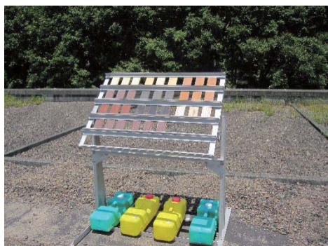
図-8 屋外暴露架台の外観
